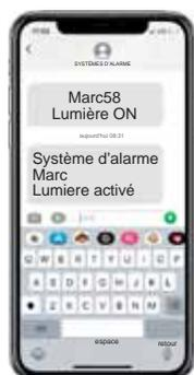
**Exemple** - L'exemple illustre un SMS d'activation de la télécommande, où le mot de passe est "Marc58" et le nom de la télécommande est "Lumière".
